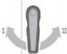
Безопасный замок дверцы защищает от ожога выходящим горячим паром. Дверца рабочей камеры открывается 2-кратным нажатием на ручку (тип 61, 101,62, 102 и XS тип 6 %).
