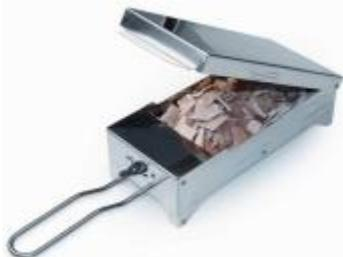
Дымогенератор из нержавеющей стали устанавливается на любой уровень пароконвектомата серии 61/101/201 для копчения мяса, рыбы или овощей в пароконвектоматах 61-201. Коптильня заполняется стандартными материалами для копчения (кроме опилок), помещается на ровную гастроемкость и ставится в аппарат над продуктом. Возможно использовать ручные или автоматические настройки пароконвектомата. Не предназначена для холодного копчения, рекомендуемая температура для приготовления - 150°C.
