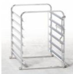
Рама с направляющими стандартная на 6 гастроемкостей GN 1/1 для пароконвектоматов серии 61. Изготовлена из нержавеющей стали. Может использоваться только в сочетании с планкой-направляющей
