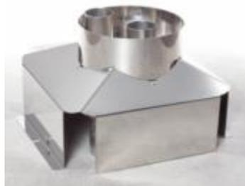
Предохранительное устройство контроля за потоком газа с глушителем для газовых пароконвектоматов 62 модели. Для отвода выхлопных газов в трубу (диаметр выпускной трубы 180 мм).
