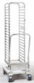
Рама с 16 уровнями GN 1/1 с направляющими для быстрой и удобной загрузки и разгрузки пароконвектомата 201 модели. Изготовлена из нержавеющей стали. Расстояние между уровнями 80 мм. Максимальная высота загрузки составляет 1,6 м. 4 tandemных управляющих колеса (2 - со стопорным тормозом).
