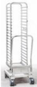
Рама с 17 уровнями GN 1/1 с направляющими для быстрой и удобной загрузки и разгрузки пароконвектомата 201 модели. Изготовлена из нержавеющей стали. Расстояние между уровнями 74 мм. Максимальная высота загрузки составляет 1,6 м. 4 tandemных управляющих колеса (2 - со стопорным тормозом).
