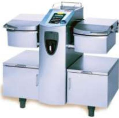
Устройство с двумя тигелями может работать в автоматическом и ручном режимах. Диапазон рабочей температуры: 30 - 250°C. Возможно одновременное приготовление в двух различных рабочих средах (например, паста и соус или стейки и фритирование).
